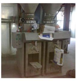
双嘴包装机是两台单嘴包装机拼合在一起的包装机,可以一个操作工人操作两台机器,更加节约人工,提高生产效率。
